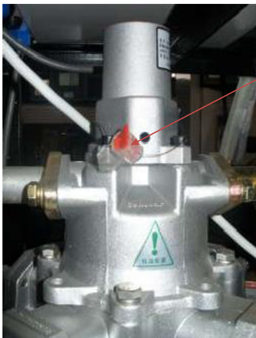
Рисунок 3 - Схема пломбировки датчика импульсов
